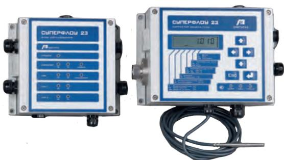
Для измерения физических свойств газа используются высокостабильные первичные преобразователи: встроенный в корпус корректора кремниевый пьезорезистивный преобразователь абсолютного давления с разделительной диафрагмой из нержавеющей стали, обеспечивающий высокую стойкость к перегрузкам, и выносной платиновый термопреобразователь сопротивления проволочного типа.
